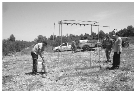
Figura 2. Vista del simulador de lluvia durante una de las pruebas en campos de cultivo. La parcela mostrada es idéntica a la utilizada en las zonas de matorral.
